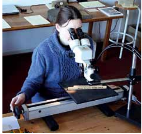
Opmåling af årringbredderne på en af boreprøverne.
